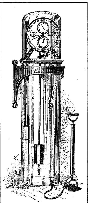
い。只一つの重りがある。此の重りが一秒ごとに少しづゝ落る。遂に下にある突き當りに當る、此の時に電流が働いて重りはもとの位置に返る。この事が二十六秒位に繰り返され、時計はどんぐり進行する。別に巻く必要はない。振子の棒はニッケル鋼で、其上端は一つの刃に掛けてある之の刃は瑪瑙の圓板の上に置かれてある。重りは真鍮である。器械全部は鋼製の心棒以外、皆な鍍金してある。此の時計の歩度の加減は振子の最下の螺子です
