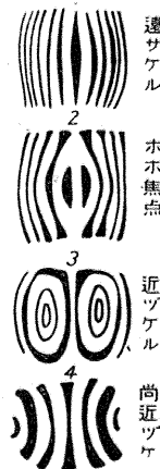
第 17 圖 補正不足の球面収差の場合
