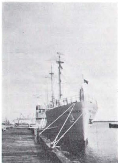
⑤は同時に電波観測も行なっていて、レーダー電波送信機を備えたレンジリカバラーという軍艦である。左側のアンテナが送信用で、ロケット打上げ期には、大西洋上に出て行って電波を発信する。受信装置は陸上5カ所にあり、光学観測データーと組合せて流星発光機構をしらべるのが目的である。
