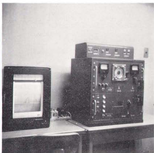
1. 計機室の自動操縦装置と温度、湿度、気圧の記録器
