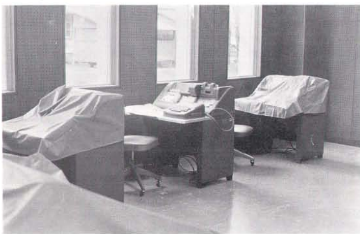
⑥ 自動記録読取装置で、各種記録計等によって、画かれたグラフチャート類を整理分析するため、グラフ面を目で追いながら、物差により、その尺度を読み取り、自動的に書直されて、印字され、なおパンチカード作製も同時に行われるものである。手前はタイプ印字のみが行われ、窓側のものは、穿孔機に連動されている。天文台測光部所属の装置で、便宜上計算室におかれている。
