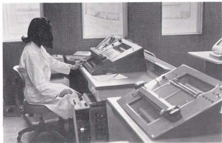
⑥ 自動記録読取装置で、各種記録計等によって、画かれたグラフチャート類を整理分析するため、グラフ面を目で追いながら、物差により、その尺度を読み取り、自動的に書直されて、印字され、なおパンチカード作製も同時に行われるものである。手前はタイプ印字のみが行われ、窓側のものは、穿孔機に連動されている。天文台測光部所属の装置で、便宜上計算室におかれている。
