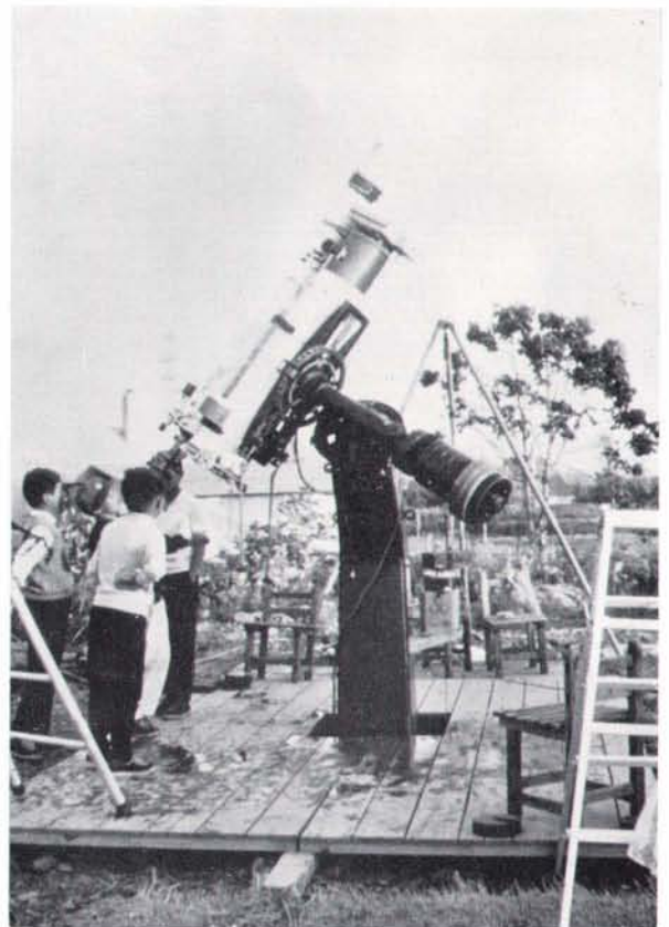
(右) 旭川市高台小学校に据付けを終った旧ブラッシャーを改造した 20 cm 天体写真儀。
