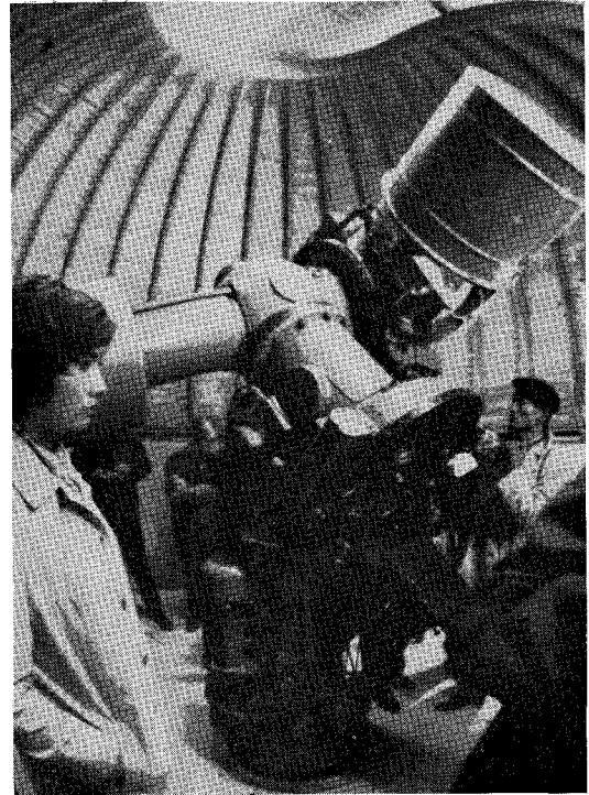
第4図 クリミヤ天文台、テレビ観測用の60センチ、メニスカス望遠鏡 (船田工氏撮影)
