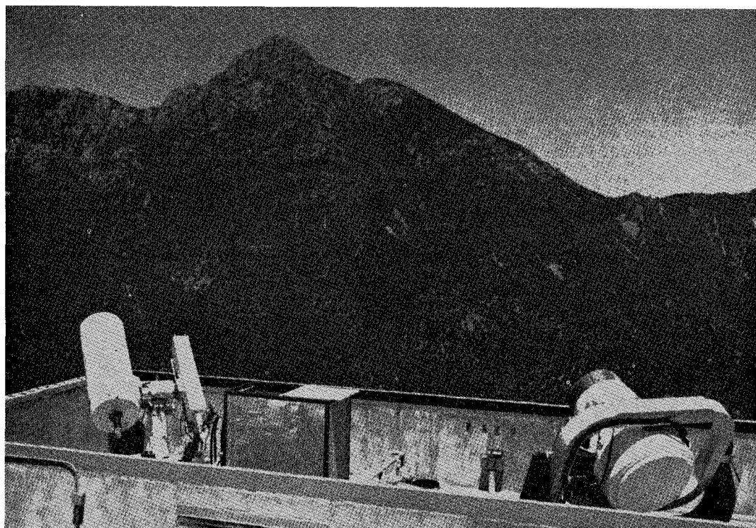
第1図 アメリカのアリゾナ州マウント・ホプキンスにあるスミソニアン天文台のレーザー測距儀（左側）とペーカークン・シュミットカメラ（右側）。
