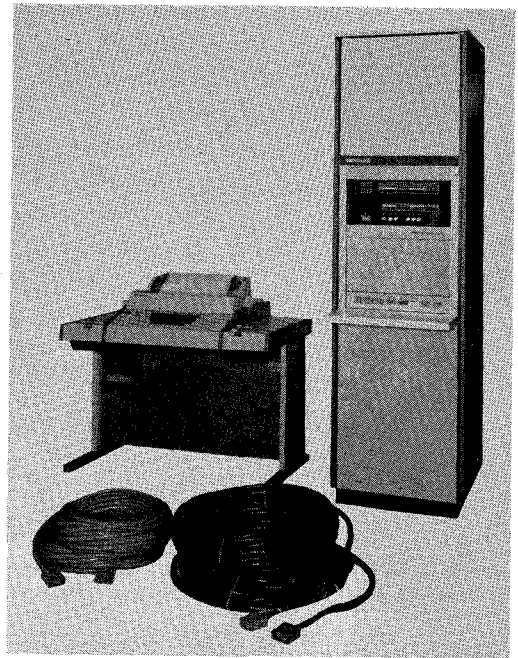
第3図 望遠鏡トラッキング用計算機
