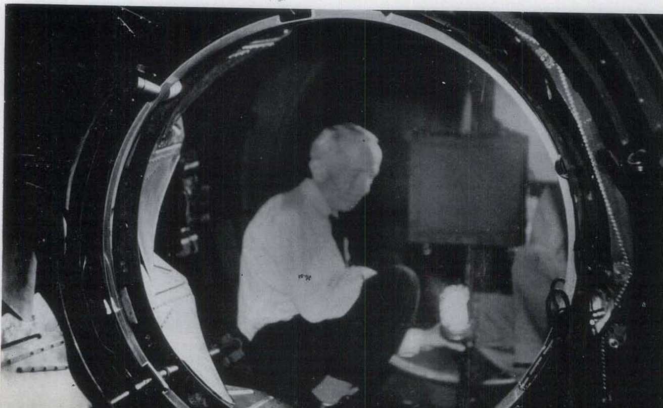
▼ ハンブルク天文台 80 cm シュミットの鏡筒内へ入って主鏡側を見たところ。主鏡の花卉式カバーや、焦点部へ乾板ホルダーの取付いているのがうつっている。ハンドランプをかざしてくれているのはリュベックさん。
