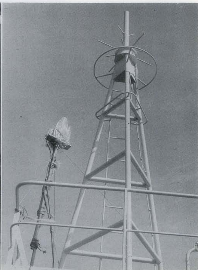
▼▲ 昭洋の航海衛星観測装置 Magnavox 702/HP およびアンテナ. ドップラー観測により陸上で \pm 50 m, 海上で \pm 200 m の位置決定度を持つ.
