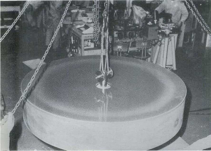
◀ 主鏡素材の吊上げ作業
