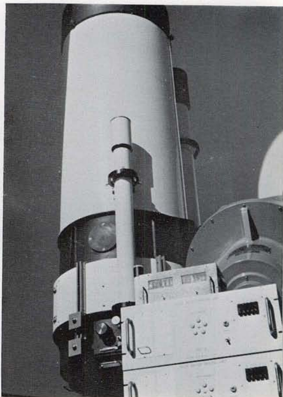
▲ パルスモーターの電源部: 上の箱はカウンター表示部, 背景の望遠鏡は手前から8cm案内鏡, 60cm主鏡, 15cm屈折望遠鏡.
