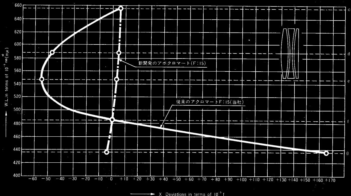
色消レンズが日本で製作されて、すでに半世紀。でも、完璧なアポクロマートとなると、計算や理論上では可能でも実際には実現不可能とさえ言われていました。3枚のレンズを枠に納めた時の芯出し精度、面精度、ホモジニティ(均質度)などに、想像を絶する精度が要求されるからです。これらの難問を五藤光学がはじめて打破
