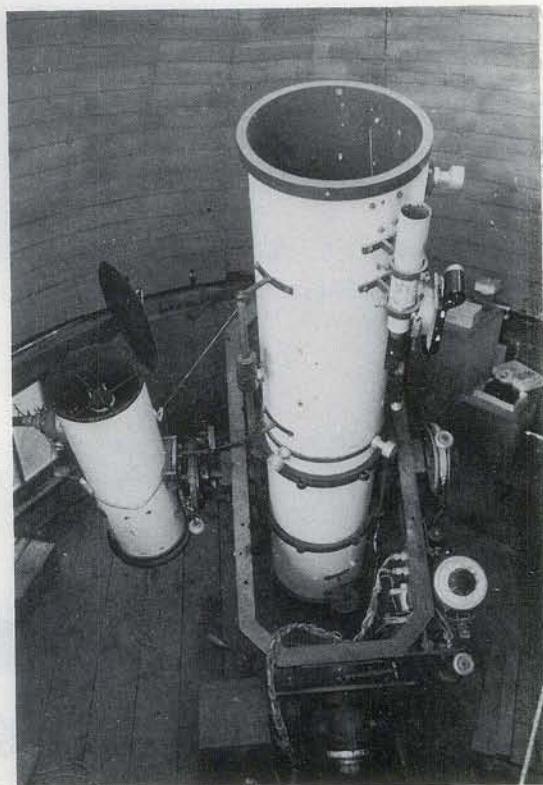
▲ 31.5 cm 反射赤道儀 21.5 cm F/3.8 反射案内鏡が同架されている
