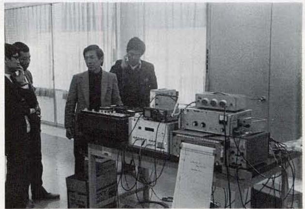
▲ 実験に使用された装置のバック・エンド部 左から VTR, 相関信号発生部, モニター用記録計などがある。
