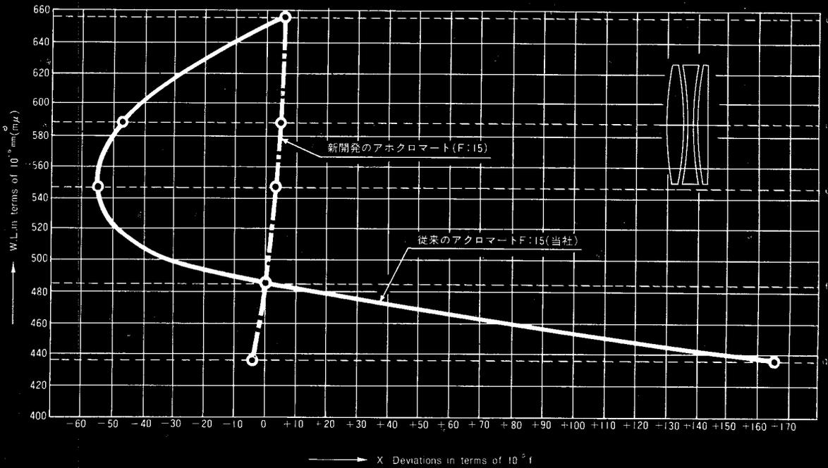
色消レンズが日本で製作されて、すでに半世紀。でも、完璧なアポクロマートとなると、計算や理論上では可能でも実際には実現不可能とさえ言われていました。3枚のレンズを枠に納めた時の芯出し精度、面精度、ホモジニティ(均質度)などに、想像を絶する精度が要求されるからです。これらの難問を五藤光学がはじめて打破
