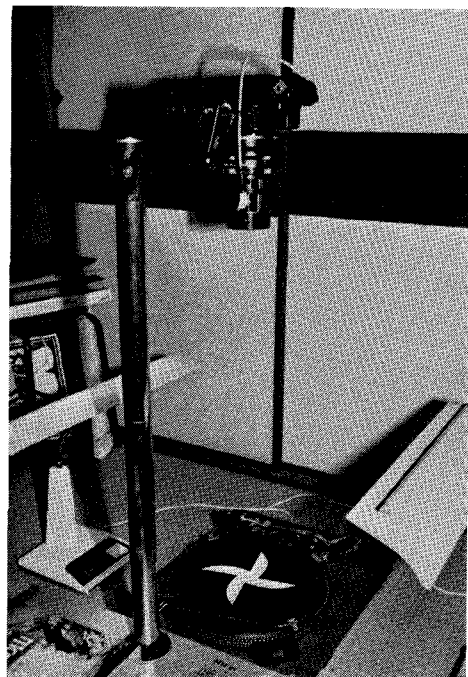
図3 ニューカークフィルター露光装置 (1979.12撮影, 6\times 7 用)
