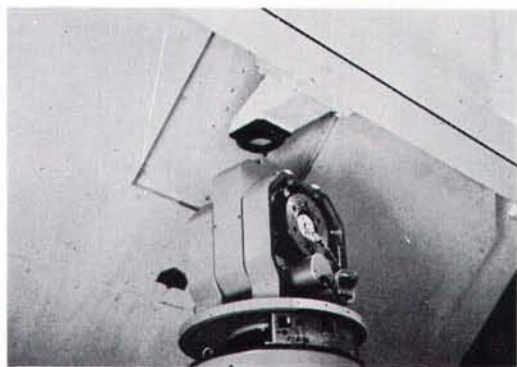
◀ 45 m 鏡の指向を決定するコリメータとの連動試験
