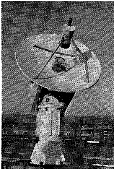
図2 ケルン大学 3m ミリ波、サブミリ波望遠鏡。
