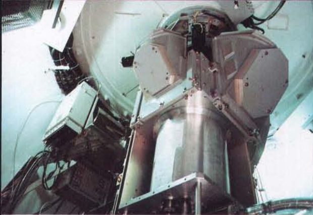
▲[写真1-①] NMAの10mアンテナ内部。中央に40/100GHz SIS受信機、左側に22GHz HEMT受信機が見える。
