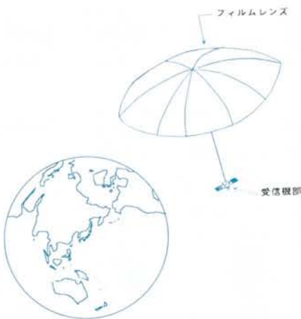
図4 巨大フィルムレンズ望遠鏡の概念図。支持機構は省いてある
