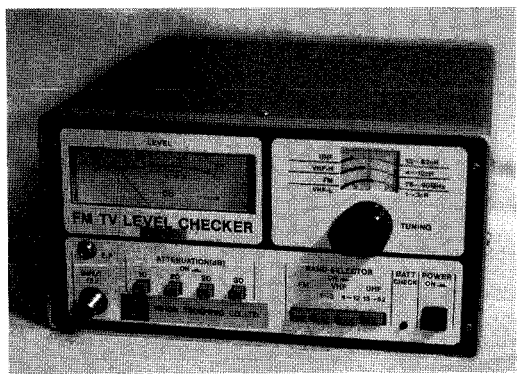
図3 780MHzの観測に用いた電界強度計。
