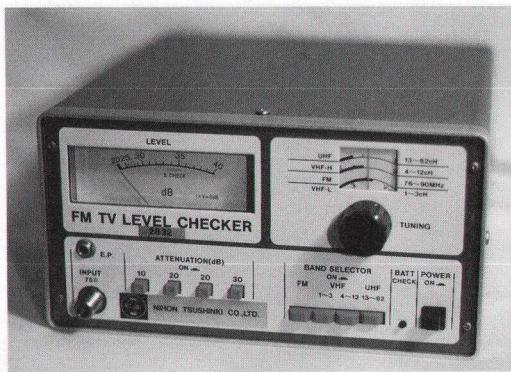
図3 780MHzの観測に用いた電界強度計。
