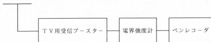
図1 780MHzの観測システムのプロック図。
