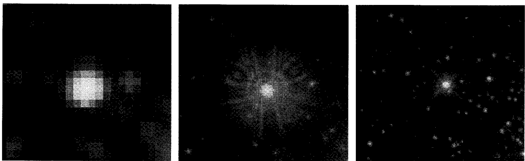
図1 大マゼラン星雲中の巨大な星形成領域にあるウォルフ・ライエ星 Melnick 34の撮像。 (左)地上における約0.6秒角の星像(欧州南天天文台 G. Meylan 博士による)。(中)WF/PC-Iによる撮像。主鏡の球面収差の影響で、星の周囲に4秒角にわたる“スカート”が見える。(右)補正鏡付きのWF/PC-IIによる撮像。0.1秒角の星像を達成し、背景の暗い星の測光も可能となった。(STScI HSTNEWSより)
