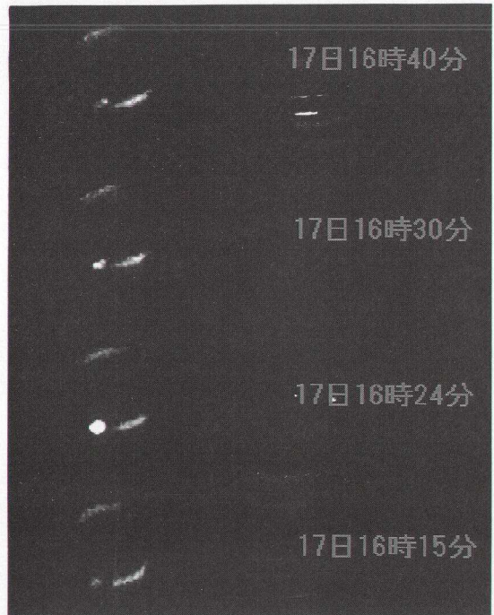
国立天文台岡山天体物理観測所188cm望遠鏡+近赤外線多目的カメラ「OASIS」によって捉えた3番目の核Cの衝突によるきのこ雲の変化。高温のきのこ雲が成長し、消滅していく様子がわかる。木星はこの波長(2.3ミクロン)では南北両極しか写らない。
