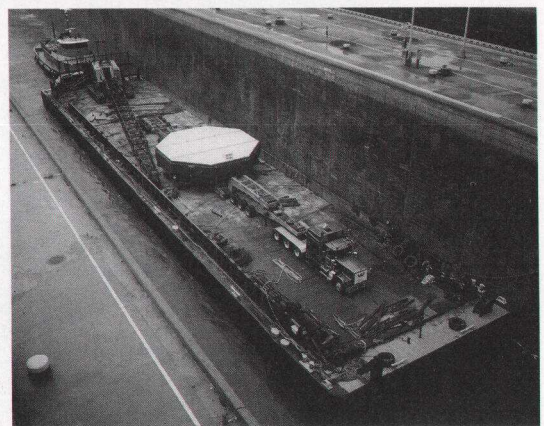
写真5 ウィーランド運河を通過中のバージ。主鏡材はトレーラー上の白い8角形のコンテナに収められている。
