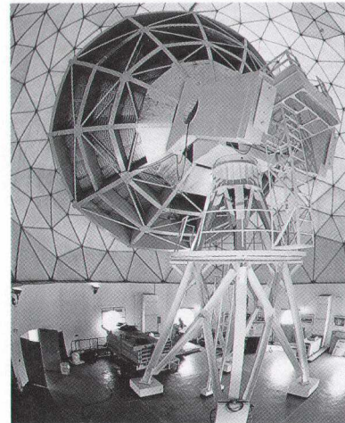
図1 大田大徳研究団地に設置されている韓国天文台の14m電波望遠鏡。レドームに囲まれているミリ波観測用で、現在7mm, 3mm, 2mm帯域の受信機がある。
