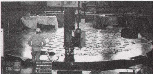
③ターンミラーによる穴あけ，直径9.2m，特別治具で2枚重ねの基板を押さえ，加工精度は数10 \mu m
