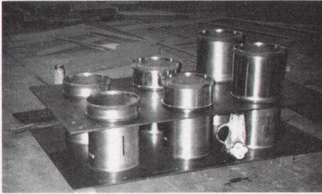
①6穴の部分モデル，溶接後の伸縮の影響と加工性を調べ，製作開始のめどを得た
