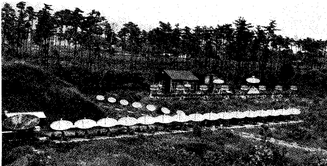
1964年頃のアンテナ群 手前から18素子9.4GHz干渉計、偏波受信用1/4波長板付8素子4GHz干渉計、後列右から1GHz偏波計、2GHz偏波計、3.75GHz偏波計、9.4GHz偏波計
