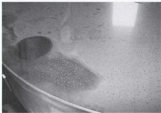
写真1 洗浄前の1.6メートル赤外シミュレータの鏡。白く点々となっている所はメッキ面がはがれている場所。
