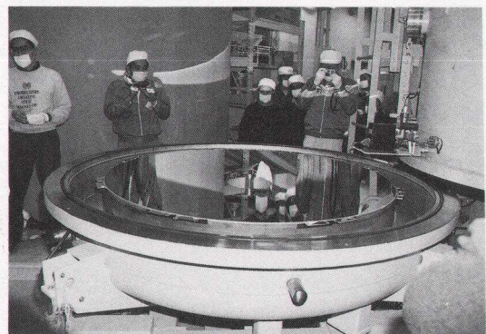
写真4 蒸着が終わって鏡が釜から出てくるところ、鏡の周囲に長方形のプレパレートが置いてあるのがわかります。
