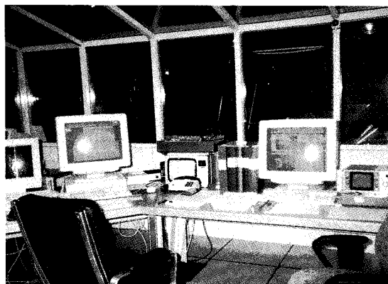
20 m望遠鏡コントロール室 受信機の調整は望遠鏡の中まで行かなくても、この部屋から全て操作することができます。望遠鏡は窓の向こうのドームの中に入っています。
