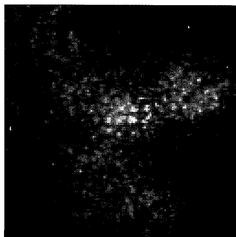
図1 メキシコ、サンペドロ天文台 212cm 望遠鏡で観測された連星 HD185936 の短時間露光像。観測波長 630nm, 画角 2.3"×2.3"。大気ゆらぎのため二重星の構造が全く分からなくなっている。
