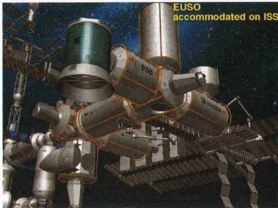
↑ 図 12 スペースステーションに取り付けられた EUSO 検出器の想像図 3) 。ESA コロンブスモジュールの先に取り付けられる予定。60 度の視野角をもつ広視野望遠鏡により地球大気を眺め, 大気中での超高エネルギー宇宙線による空気シャワーを蛍光で測定する。 10^{20} 電子ボルト宇宙線に対して直径 500 km の円内を検出エリアとする。その巨大なターゲットボリュームにより, 超高エネルギーニュートリノの検出が期待される。
