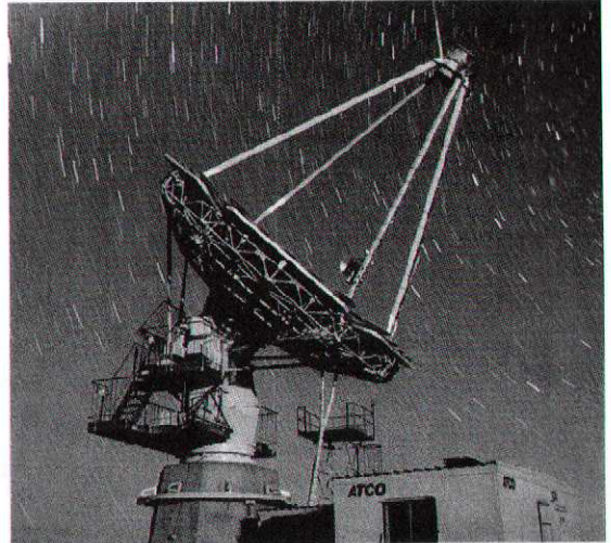
ウーメラの CANGAROO 10 m 解像型チェレンコフ望遠鏡。
