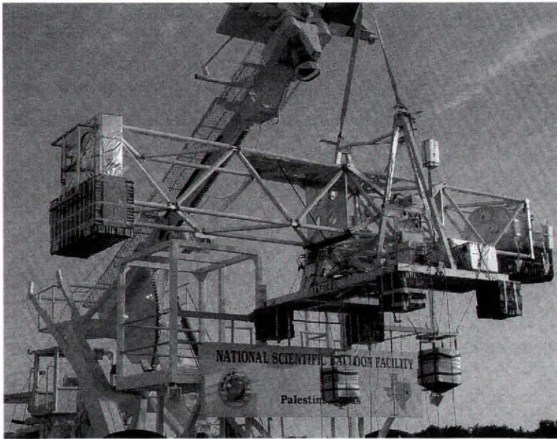
図4 InFOC \mu S 気球搭載観測装置 (ゴンドラ)
