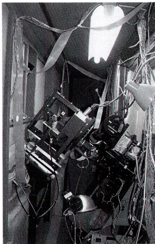
図8：HIDESの入り口スリット前に取り付けられたコードセル（手前）とイメージローテータ（奥）
