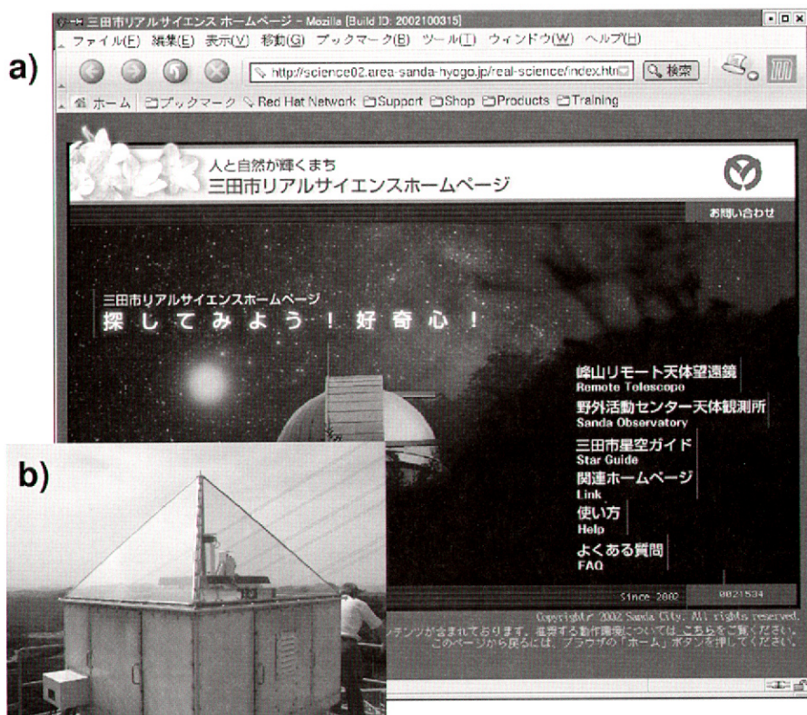
図1 「三田市リアルサイエンス」ホームページ (a) と、ガラスピラミッドに密封されたリモート望遠鏡の写真 (b)
