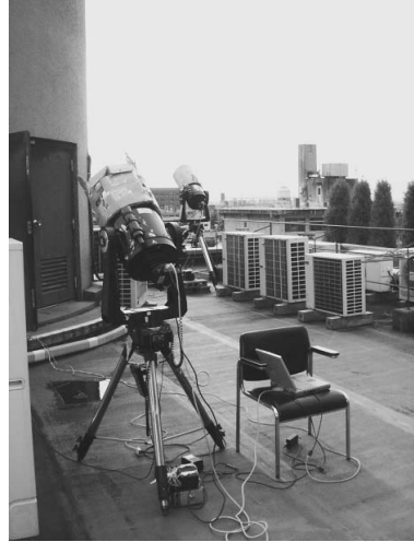
図1 京都大学宇宙物理学教室屋上での観測の様子。手前に見えるのが25-cm望遠鏡で奥に見えるのが30-cm望遠鏡。鏡筒にかぶっているのは段ボールの筒で、吸水性が良いことから結露対策に、また雑誌をぺたぺた張りつけてバランスウェートの役割も果たす優れたもの。望遠鏡・CCDカメラはセットアップ後は研究室から制御する。冬場などは、気がついたら望遠鏡と制御用ノートパソコンが雪に埋もれている、などということもあるとかないとか。
