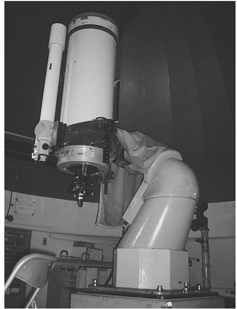
写真 2 東京学芸大学 40 cm 望遠鏡。冷却 CCD カメラによる撮像観測または眼視観測が可能。
