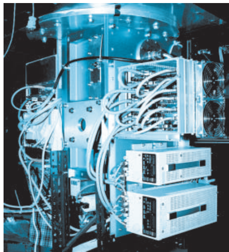
図 1 SIRIUS 外観。中央の部分が真空容器，その周りに読み出し回路や直流電源が取り付けられている。
