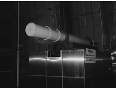
写真7 自動光電子午環の南北の視準器.
