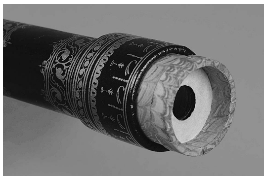
図4 復元した20倍望遠鏡の接眼部。先端はマール紙で飾っている。ガリレオが鏡筒装飾に使った、革製品、金細工、マール紙、これらはフィレンツェ伝統の名産品である。
