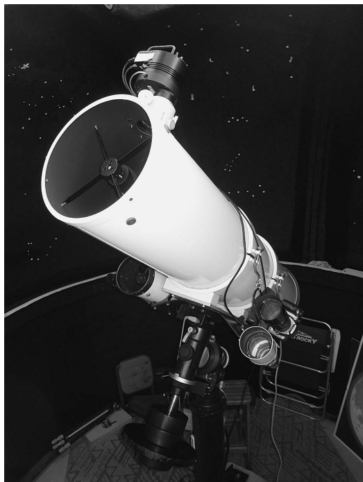
写真2 30センチ F5.3 ニュートン. CCDカメラ: ST-2000XM タカハシ160システム赤道儀(自動導入改造)
