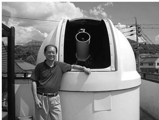
写真 1 2 階建て平屋根の屋上に作ったマイドーム。直径 2.5 m ドーム、内面は蛍光シールで星座を描き簡易プラネタリウムになっています。ドーム左のペントハウスが観測室になっています。
