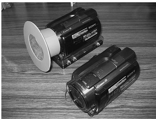
図1 使用したビデオカメラと手製減光フィルター。
