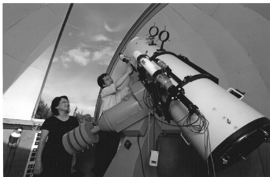
図1 浜野和天文台の観測設備、観測ドーム内のD=400 mm, f1=1,800 mmメイン望遠鏡および浜野和と共同観測者である妻の博子。
