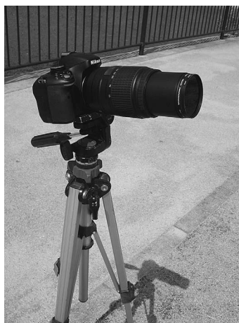
図5 今回のデータの観測機材 (奈良県香芝市新池公園; 北緯34.5294°, 東経135.7128°). カメラはニコンD5100, 三脚は小型軽量のSLIKコンパクトで、どちらも市販品である.
