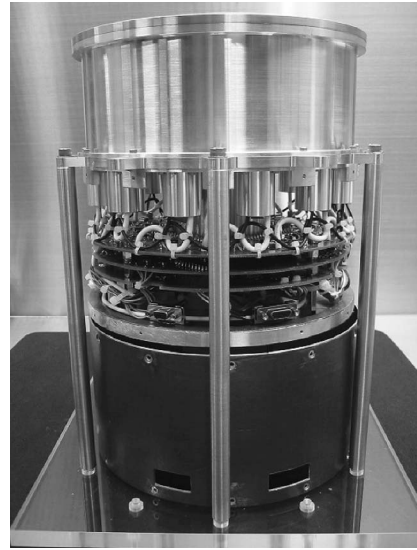
図2 われわれが開発したGAP。写真では中が見えるように横を覆う円柱状のカバーを下げている。
