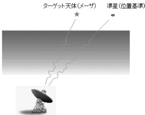
図3 2ビーム観測による大気屈折率揺らぎ補償（位置補償）の概念図。ターゲット天体（メーザー）と基準天体（準星、キューサー）が十分近ければ大気の変動は共通と考えられるので、同時観測することで揺らぎを補正することが可能になります。
