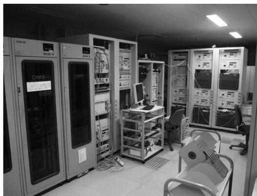
図6 三鷹相関処理局。左手前のテープカートに磁気記録装置DIR-2000が4台稼働、正面にFX型相関処理装置と計算機によるソフトウェア相関器が稼働。
