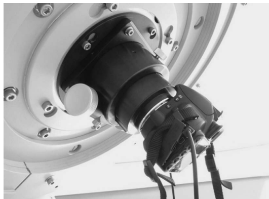
写真5 K社から購入したマイクロフォーカス接眼部。発見時は1分露出後、すぐにスマホで確認していたが、効率を良くするため30秒露出とし、100-200天体を連続撮影し、SDカードを取り出してリビングに移動し、パソコン画面に表示しスマホと見比べる方法に切り替えた。一晩中晴れていれば600天体程度の撮影と確認が可能となった。
