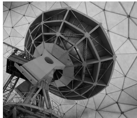
図4b 中国・PMOの14 mミリ波望遠鏡。(Delingha, 青海; 韓国と同じESCO社製, 2000年頃から精力的に運用)。
